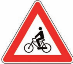
Figura II 14 Art.88 ATTRAVERSAMENTO CICLABILE Presegnala un attraversamento ciclabile, contraddistinto da appositi segni sulla carreggiata, sulle strade extraurbane e quelle urbane con limite di velocità superiore a quello stabilito dall'art.142, comma 1, del codice.
