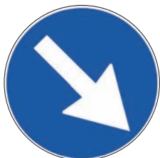
Figura II 82/b Art.122 PASSAGGIO OBBLIGATORIO A DESTRA Obbliga i conducenti a passare a destra di un ostacolo, un'isola, un salvagente, un cantiere stradale, uno spartitraffico, ecc.
