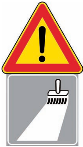
Figura II 391 SEGNI ORIZZONTALI IN RIFACIMENTO Presegnala un pericolo dovuto alla mancanza della segnaletica orizzontale, ovvero lavori di tracciamento in corso sul tronco stradale.
