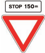
Figura II 39 Art.108 PREAVVISO DI FERMARSÌ E DARE PRECEDENZA Presegnala la successiva presenza di un segnale "Fermarsi e Dare precedenza (Stop)", indicando anche la distanza dall'intersezione.
