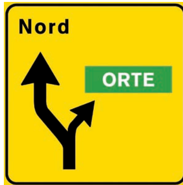
Figura II 406 PREAVVISO DI DEVIAZIONE Il pannello è da impiegare nei casi in cui la zona di deviazione ricade nell'area di uno svincolo; entro l'inserto, il cui colore di fondo è quello caratteristico del tipo di uscita, va riportata la denominazione dell'uscita ed a sinistra in alto il capostrada o la direzione geografica principale.
