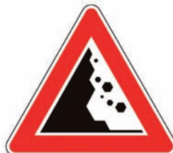
Figura Il 30/a Art.98 CADUTA MASSI Presegnala un tratto di strada ove esiste il pericolo, a seguito di caduta di pietre da sinistra, di presenza delle medesime sulla carreggiata.
