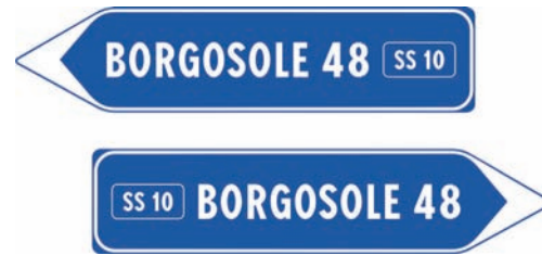
Figura II 249 Art.128 SEGNALE DI DIREZIONE EXTRAURBANO Nel segnale può essere inserito un simbolo fra quelli di cui alle Figure da II 100 a II 231 o il numero di strada. Questi sono posti dalla parte opposta a quella della freccia. La cifra indicante la distanza espressa in chilometri (senza la sigla km) deve sempre seguire il nome della località ed è obbligatoria.
