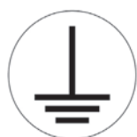
1159 70 10 messa a terra
