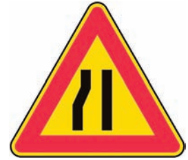
Figura II 385 STRETTOIA ASIMMETRICA A SINISTRA Presegnala un restringimento pericoloso della carreggiata posto sul lato sinistro.
