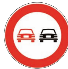
Figura II 48 Art.116 DIVIETO DI SORPASSO Vieta di sorpassare i veicoli a motore, eccetto i ciclomotori e i motocicli, anche se la manovra può compiersi entro la semicarreggiata con o senza striscia continua.
