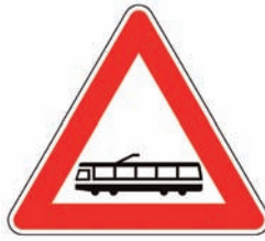
Figura II 12 Art.88 ATTRAVERSAMENTO TRAMVIARIO Presegnala, fuori e dentro i centri abitati, una linea tramviaria non regolata da semafori, che interseca, interferisce o riduce la carreggiata stradale.
