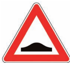
Figura II 2 Art.85 DOSSO Presegnala una anomalia altimetrica convessa della strada.
