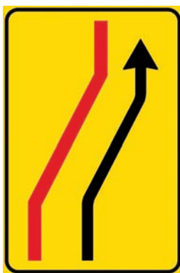
Figura II 412/c SÉGNALE DI RIENTRO IN CARREGGIATA Indica la chiusura della carreggiata con conseguente deviazione su una corsia della carreggiata opposta oppure sulla eventuale corsia di emergenza.
