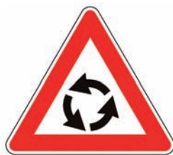
Figura Il 27 Art.96 CIRCOLAZIONE ROTATORIA Presegnala sulle strade extraurbane una intersezione regolata con circolazione rotatoria.
