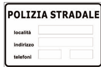
Figura Il 378 Art.136 POLIZIA STRADALE Indica la sede più vicina di un posto, un comando, un ufficio di un organo di polizia. Il segnale è installato lungo la viabilità extraurbana in prossimità del centro abitato e precisa la località, indirizzo e numeri telefonici. Per indicare successivamente la direzione del posto, comando od ufficio, si impiegano normali segnali di direzione, o di conferma, a fondo bianco.
