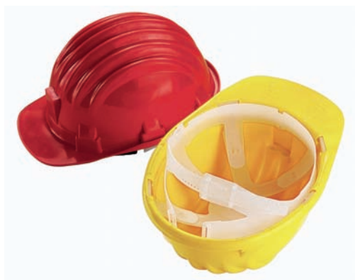
Articolo 0240 ELMETTO PROTETTIVO Elmetto di protezione a Norma CE (EN 397) in polietilene HD, interno in nylon, parasudore in spugna e tessuto assemblato, sistema di regolazione manuale facile e veloce, predisposizione per l'inserimento di cuffie e visiera che utilizzano attacchi da 30 mm.
