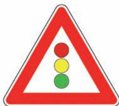
Figura Il 31/a Art.99 SÈMAFORO Presegnala un impianto semaforico con disposizione delle lanterne in verticale.
