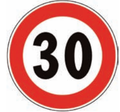
Figura II 50 LIMITE MASSIMO DI VELOCITÀ ... KM/H Vieta di superare la velocità indicata in Km/ora, salvo limiti inferiori imposti a particolari categorie di veicoli.
