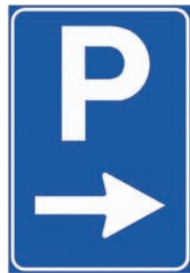
Figura Il 77 Art.120 PREAVVISO DI PARCHEGGIO Mediante frecce opportunamente orientate indica la direzione verso aree o infrastrutture di parcheggio.
