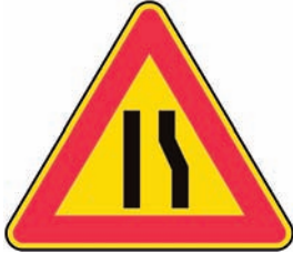
Figura II 386 STRETTOIA ASIMMETRICA A DESTRA Presegnala un restringimento pericoloso della carreggiata posto sul lato destro.
