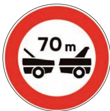
Figura II 49 Art.116 DISTANZIAMENTO MINIMO OBBLIGATORIO DI ... METRI Vieta di seguire il veicolo che precede ad una distanza inferiore a quella indicata in metri sul segnale.
