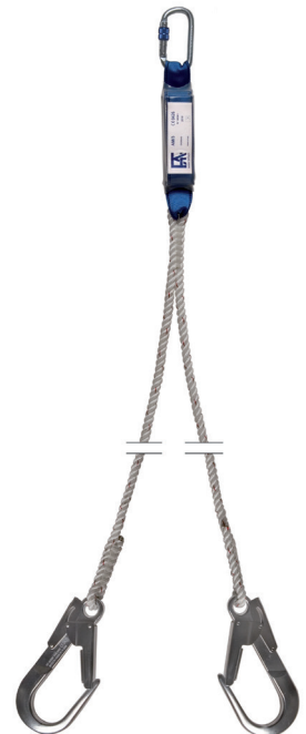
Articolo 045 ASSORBITORE DI ENERGIA A "Y" Con 1 moschettone ovale con ghiera in acciaio (Articolo 09) e 2 moschettoni con chiusura a doppia leva in lega (Articolo 013). Conforme alla Norma EN 355.
