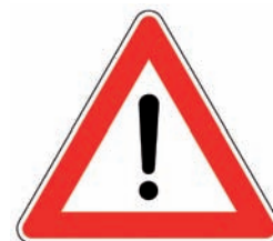
Figura Il 35 Art.103 ALTRI PERICOLI Presegnala un pericolo diverso da quelli indicati negli altri segnali di pericolo. È obbligatorio un pannello integrativo Modello Il 6 recante un simbolo od una iscrizione che precisi la natura del pericolo.
