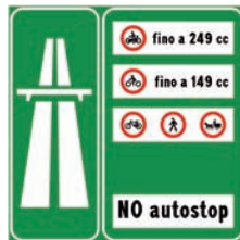
Figura II 347 Art.135 PREAVVISO DI INIZIO AUTOSTRADA, PREAVVISO DI INIZIO STRADA EXTRAURBANA PRINCIPALE Indica l'inizio di un'autostrada o di una strada extraurbana principale. Posto all'inizio del tronco di raccordo con la viabilità ordinaria vale a richiamare le speciali norme di circolazione vigenti in autostrada o sulla strada extraurbana principale. Il colore di fondo è verde per l'autostrada e blu per le strade extraurbane principali.
