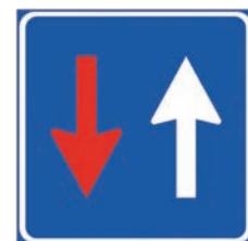
Figura II 45 Art.114 DIRITTO DI PRECEDENZA NEI SENSI UNICI ALTERNATI Indica che il conducente ha la precedenza di passaggio rispetto alla corrente di traffico proveniente in senso inverso nelle strettoie nelle quali è stato istituito il senso unico alternato.
