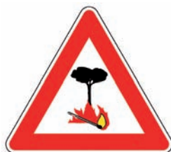
Figura Il 34 Art.102 PERICOLO DI INCENDIO Richiama l'attenzione sul pericolo di infiammabilità di zone boschive o la vicinanza di luoghi ad alto rischio di incendio contigui alla strada.
