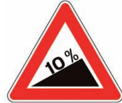
Figura II 16 Art.89 SALITA RIPIDA Presegnala una salita ripida pericolosa in conseguenza di fattori locali particolarmente sfavorevoli. La pendenza è espressa in percentuale.
