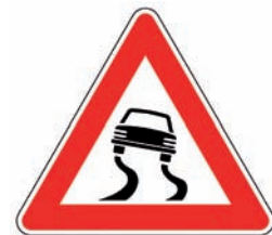
Figura II 22 Art.93 STRADA SDRUCCIOLEVOLE Presegnala un tratto di carreggiata che, in particolari condizioni, può presentare una superficie pericolosamente sdruciolevole.
