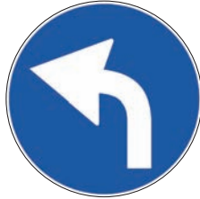
Figura II 80/e Art.122 PREAVVISO DI DIREZIONE OBBLIGATORIA A SINISTRA Preavvisa l'obbligo di voltare a sinistra.
