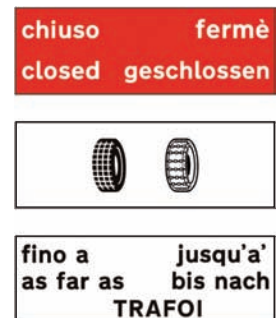
Figura II 336 Art.135 TRATTO TERMINALE DELLA STRADA O PASSO CHIUSO Percorribile fino alla località indicata con catene o pneumatici da neve raccomandati.
