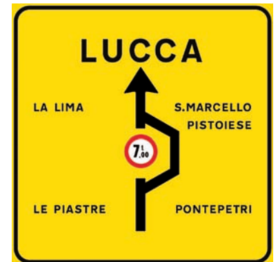
Figura II 408 PREAVVISO DI DEVIAZIONE Esemplifica una limitazione di transito lungo un tronco di strada, vietandolo ai veicoli aventi una massa totale superiore a 7,0 t ed indica l'itinerario alternativo percorribile da parte di tali veicoli.
