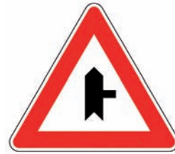
Figura II 43/b Art.112 INTERSEZIONE A "T" CON DIRITTO DI PRECEDENZA Presegnala una intersezione a "T" con una strada subordinata che si immette dalla destra.
