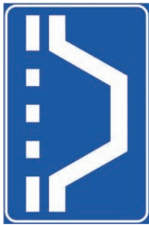
Figura II 328 Art.135 PIAZZOLA SU VIABILITÀ ORDINARIA Indica l'esistenza di una piazzola a lato della carreggiata per effettuare una fermata.
