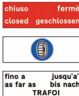
Figura II 335 Art.135 TRATTO TERMINALE DELLA STRADA O PASSO CHIUSO Percorribile fino alla località indicata con obbligo di catene o pneumatici da neve.
