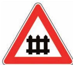
Figura II 8 Art.87 PASSAGGIO A LIVELLO CON BARRIERE Presegnala un attraversamento ferroviario munito di barriere o semibarriere.
