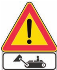
Figura II 388 MEZZI DI LAVORO IN AZIONE Presegnala un pericolo costituito dalla presenza di macchine operatrici, pale meccaniche, escavatori, uscita autocarri, ecc. che possono interferire con il traffico ordinario.
