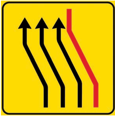
Figura II 412/f SEGNALE DI RIENTRO IN CARREGGIATA Indica il rientro nella carreggiata normale di marcia.
