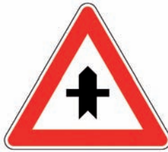
Figura II 43/a Art.112 INTERSEZIONE CON DIRITTO DI PRECEDENZA Presegnala una intersezione nella quale il conducente ha la precedenza sui veicoli provenienti dalle strade subordinate.
