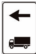
Figura II 351 Art.135 DIREZIONE AUTOCARRI CONSIGLIATA Segnale di direzione consigliata per i veicoli di trasporto di cose. Nel pannello sono indicate le categorie di veicoli cui è consigliata la deviazione.
