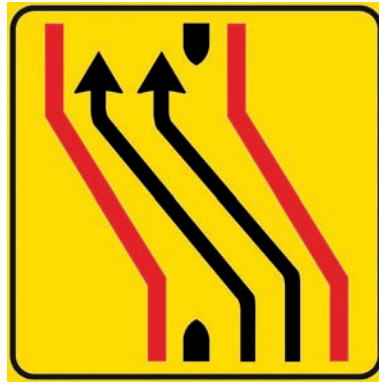
Figura II 413/a SEGNALE DI CARREGGIATA CHIUSA Indica la chiusura della carreggiata con conseguente deviazione, in parallelo, su due corsie della carreggiata opposta.
