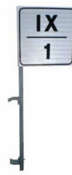
Figura Il 262/c Art.129 SEGNALE DI PROGRESSIVA ETTOMETRICA Cippo ettometrico bifacciale in alluminio 10/10 con telaio zincato per attacco al guard-rails.
