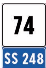
Figura II 266 Art.129 PROGRESSIVA DISTANZIOMETRICA PER STRADA STATALE
