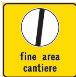
Figura 530 FINE AREA CANTIERE
