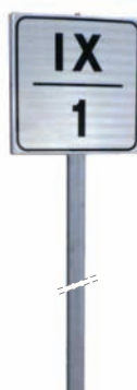
Figura Il 262/b Art.129 SEGNALE DI PROGRESSIVA ETTOMETRICA Cippo ettometrico bifacciale scatolato in alluminio 10/10 completo di paletto in canna rettangolare da 15x35 cm zincato, altezza totale 150 cm.
