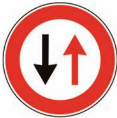
Figura II 41 DARE PRECEDENZA NEI SENSI UNICI ALTERNATI Indica l'obbligo di dare la precedenza alla corrente di traffico proveniente in senso inverso, nelle strettoie nelle quali è stato istituito il senso unico alternato.
