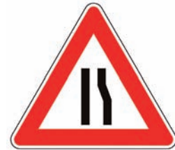
Figura II 19 Art.90 STRETTOIA ASIMMETRICA A DESTRA Presegnala un restringimento pericoloso della carreggiata posto sul lato destro.
