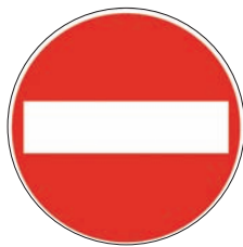
Figura II 47 Art.116 SENSO VIETATO Vieta di entrare in una strada accessibile invece dall'altra parte, in quanto a senso unico.
