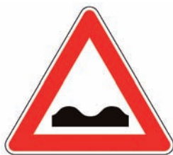
Figura II 1 Art.85 STRADA DEFORMATA Presegnala un tratto di strada in cattivo stato o con pavimentazione irregolare.
