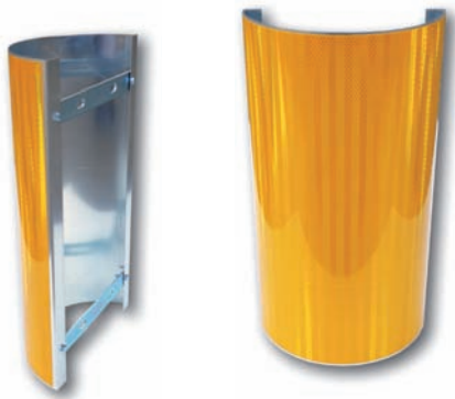
Figura II 472 DELINEATORE SPECIALE DI OSTACOLO Segnala cuspidi e testate di isole di traffico e di sparti traffico poste entro la carreggiata. È sempre accoppiato con segnali indicanti i passaggi obbligatori o consentiti. Rifrangente classe 2.
