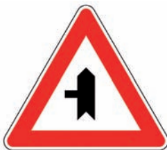
Figura II 43/c Art.112 INTERSEZIONE A "T" CON DIRITTO DI PRECEDENZA Presegnala una intersezione a "T" con una strada subordinata che si immette dalla sinistra.
