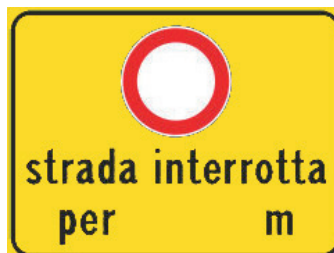
Figura 450 STRADA INTERROTTA PER ... M
