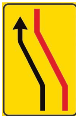
Figura II 412/d SÉGNALE DI RIENTRO IN CARREGGIATA Indica il rientro nella carreggiata normale di marcia.
