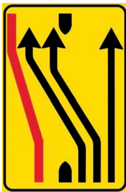
Figura II 411/g SÉGNALE DI CORSIE CHIUSE Indica la possibilità di proseguire diritto o su una delle corsie della carreggiata opposta per la presenza di una deviazione in corrispondenza di un cantiere stradale.
