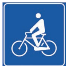
Figura II 324 Art.135 ATTRAVERSAMENTO CICLABILE
