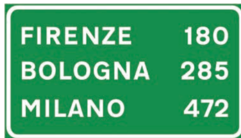
Figura II 285 Art.132 SEGNALE DI CONFERMA AUTOSTRADALE Indica le località prossime e/o lontane, con le relative distanze in chilometri. Se impiegato sulla viabilità extraurbana il colore di fondo è blu.
