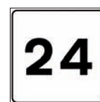
Figura Il 261 Art.129 SEGNALE DI PROGRESSIVA CHILOMETRICA
