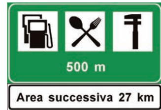
Figura Il 376 Art.136 AREA DI SERVIZIO Presegnala, mediante i simboli opportuni, i servizi esistenti in un'area attrezzata lungo strade od autostrade. Il colore di fondo è quello proprio della viabilità lungo la quale è installato.
