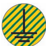
1160 00 10 messa a terra
