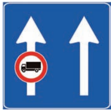
Figura II 337 Art.135 USO CORSIE Indica la corsia vietata ai veicoli di massa a pieno carico superiore a 3,5 t.
