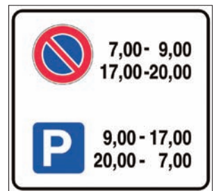
Figura Il 79/d Art.120 RÉGOLAZIONE FLESSIBILE DELLA SOSTA IN CENTRO ABITATO Esempio di segnale composito che consente la sosta in alcune ore, la vieta in altre.
