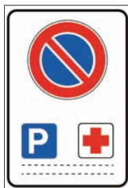
Figura Il 79/b Art.120 SOSTA CONSENTITA A PARTICOLARI CATEGORIE Sosta consentita ai veicoli adibiti al pronto soccorso.
