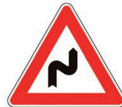
Figura II 6 Art.86 DOPPIA CURVA, PRIMA A DESTRA Presegnala una serie di curve pericolose in successione, di cui la prima a destra.
