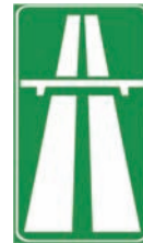
Figura II 345 Art.135 INIZIO AUTOSTRADA (COLORE DI FONDO VERDE), INIZIO STRADA EXTRAURBANA PRINCIPALE (COLORE DI FONDO BLU)
