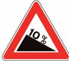
Figura II 15 Art.89 DISCESA PERICOLOSA Presegnala una discesa pericolosa in conseguenza di fattori locali particolarmente sfavorevoli. La pendenza è espressa in percentuale.
