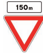
Figura II 38 Art.108 PREAVVISO DI DARE PRECEDENZA Presegnala la successiva presenza di un segnale "Dare precedenza", indicando anche la distanza dall'intersezione.
