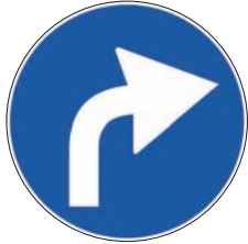
Figura II 80/d Art.122 PREAVVISO DI DIREZIONE OBBLIGATORIA A DESTRA Preavvisa l'obbligo di voltare a destra.
