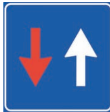
Figura II 45 DIRITTO DI PRECEDENZA NEI SENSI UNICI ALTERNATI Indica che il conducente ha la precedenza di passaggio rispetto alla corrente di traffico proveniente in senso inverso nelle strettoie nelle quali è stato istituito il senso unico alternato.
