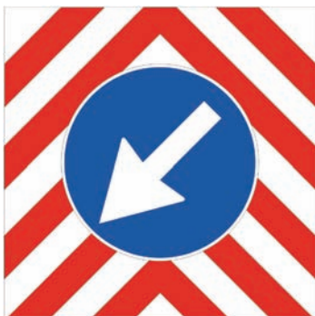
Figura II 398 PASSAGGIO OBBLIGATORIO PER VEICOLI OPERATIVI Segnale di cui devono essere dotati posteriormente i veicoli operativi, i macchinari ed i mezzi d'opera impiegati per lavori o manutenzione stradale fermi o in movimento, freccia girevole.
