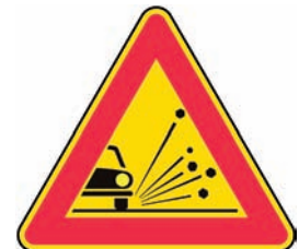
Figura II 390 MATERIALE INSTABILE SULLA STRADA Presegnala la presenza sulla pavimentazione di ghiaia, pietrisco, graniglia od altro materiale instabile che può diminuire pericolosamente l'aderenza del veicolo od essere proiettato a distanza.
