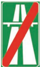
Figura II 346 Art.135 FINE AUTOSTRADA (COLORE DI FONDO VERDE), FINE STRADA EXTRAURBANA PRINCIPALE (COLORE DI FONDO BLU)
