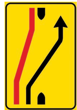
Figura II 412/b SÉGNALE DI RIENTRO IN CARREGGIATA Indica il rientro nella carreggiata normale di marcia.
