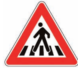
Figura II 13 Art.88 ATTRAVERSAMENTO PEDONALE Presegnala un attraversamento pedonale, contraddistinto da appositi segni sulla carreggiata, sulle strade extraurbane e quelle urbane con limite di velocità superiore a quello stabilito dall'art.142, comma 1, del codice.
