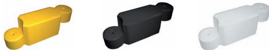
Figura 483 CORDOLO JOLLY Cordolo realizzato in plastica riciclata, ideale per la realizzazione di rotatorie di qualsiasi diametro, cordolature per marciapiedi, aiuole e isole spartitraffico. Atti a sostituire i cordoli in cemento, attenuano l'urto in caso di incidente per una maggior sicurezza. 1 m lineare = 2,5 pezzi. Dimensioni: 52x14,5x17 cm Disponibile: - giallo - bianco - nero
