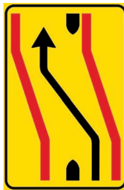
Figura II 412/a SÉGNALE DI CARREGGIATA CHIUSA Indica la chiusura della carreggiata con conseguente deviazione su una corsia della carreggiata opposta oppure sulla eventuale corsia di emergenza.
