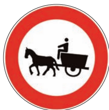
Figura II 53 Art.117 TRANSITO VIETATO AI VEICOLI A TRAZIONE ANIMALE Vieta il transito ai veicoli a trazione animale.
